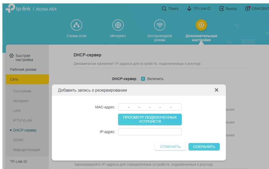
В появившемся окне укажите MAC-адрес устройства, для которого мы делаем статическую запись (для ПК или камеры). Затем укажите постоянный IP-адрес, который роутер будет выдавать этому устройству.
