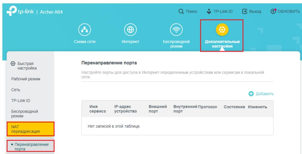
В появившемся окне укажите имя сервиса, IP-адрес устройства, внешний порт, внутренний порт, протокол. Если устройство уже подключено и получило адрес, можно просто добавить через кнопку «Просмотр Подключенных устройств».
