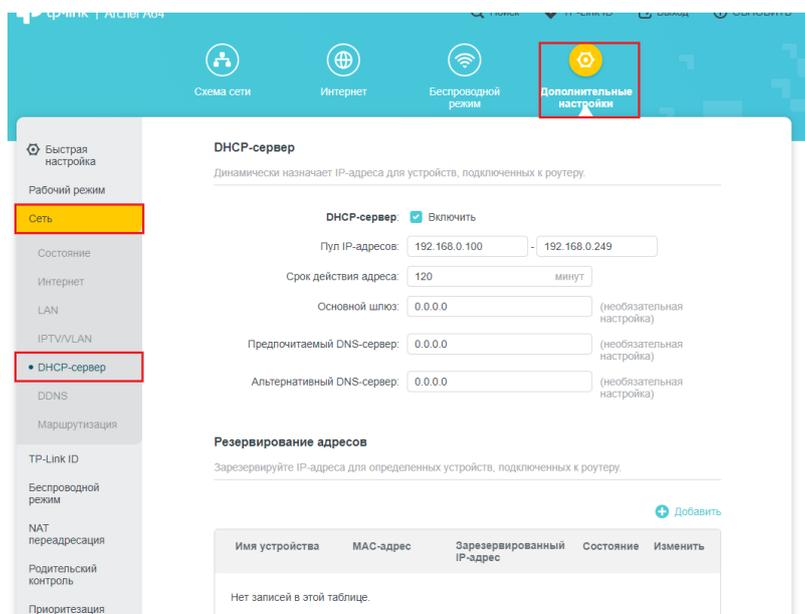
А для создания статической записи DHCP в разделе «Резервирование адресов» необходимо нажать кнопку «Добавить».
